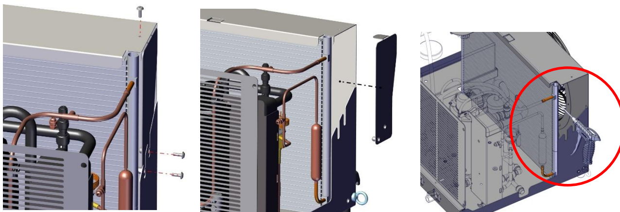
Figure 18 - Nettoyage du condenseur
