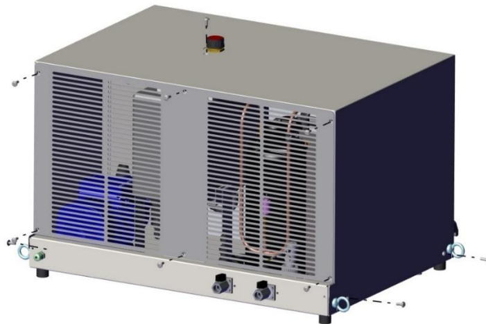
Figure 14 - vis à enlever pour avoir accès au refroidisseur
